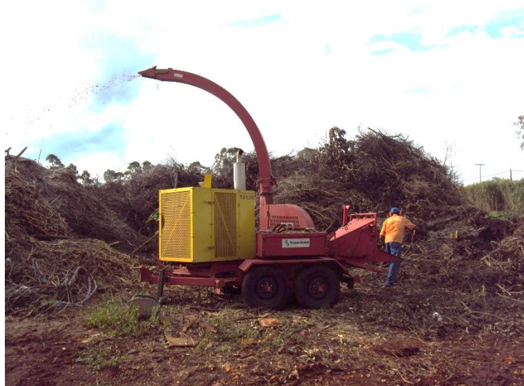
Figura 3.23 – Triturador de galhos presente no aterro de resíduos sólidos de Rolândia
