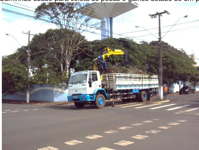
Figura 3.16 - Caminhão usado para coleta de podas e galhos dotado de um pólopo hidráulico
